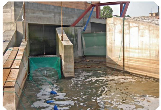
Bild 6: Für Untersuchungen zur biologischen Wirksamkeit von Fischschutz- und Fischabstiegssystemen kommen häufig Hamen (links) und Schwalgreusen (rechts) zum Einsatz, mit denen die Turbinen und der Bypass beprobt werden (Fotos: Ebel)
